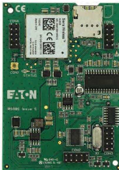
COM-DATA-4G est un module enfichable qui permet aux centrales i-on d'accéder au service Eaton SecureConnect™ via Internet en utilisant les réseaux de téléphonie mobile LTE et GSM (4G et 2G).
