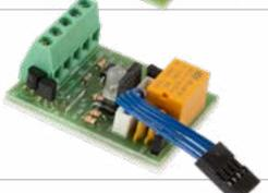
PCBEMS2448C <sup>(1)</sup><br>Carte électronique pour série EMS 24/48 V DC avec contact |                        | 0,022 Kg / 0,021 Kg    | 1               |                         | 3760351730069 |
