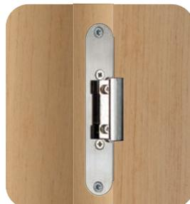
Plaque de montage sur laquelle est fixée la gâche électrique. L'ensemble têtère + gâche électrique est fixé sur la menuiserie en face de la serrure mécanique.
