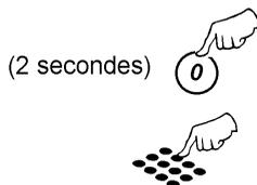
**Si le SIMPL'TECH est installé derrière un standard téléphonique**, il doit composer un code (préfixe) pour obtenir la ligne extérieure avant de composer le numéro du correspondant. Pour enregistrer une pause après le préfixe « 0 », maintenez appuyée la touche « 0 » jusqu'à ce que le transmetteur confirme l'opération. Puis relâchez la et composez la suite du numéro.
