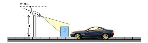
Le réglage de la distance plaque – Caméra se fait par l'outil logiciel « Caméra », voir description dans le chapitre suivant.
