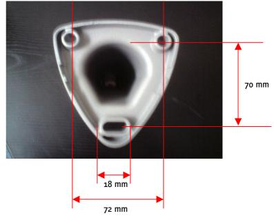
La « connecteur caméra » permet de distribuer l'alimentation de la caméra et la liaison Ethernet. La connexion Ethernet se fait sur l'entrée « LAN2 » du calculateur. L'alimentation externe est de 24V AC 100 VA. Consommation Max de 65W (Chauffahe et éclairage inclus). La fixation de la caméra est de type mural 3 points, voir les côtes de fixation ci-dessus.
