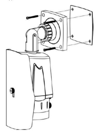
Étape 5 : Visser le support à l'aide de l'anneau de verrouillage. Ajuster la position de la caméra en fonction de vos besoins. Une fois l'ajustement fait, verrouiller la caméra comme indiqué en figure 3.4.
