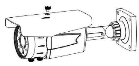
Étape 2 : Prendre le gabarit (fourni), retirer son papier protecteur et coller le gabarit sur le mur à l'endroit où la caméra doit être posée.
