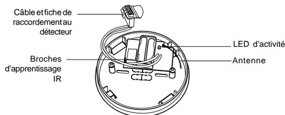
Lorsque de la fumée active le détecteur, celui-ci déclenche à son tour l'émetteur via le câble et la fiche illustrés dans la figure ci-dessus. L'émetteur adresse alors un signal au récepteur.
