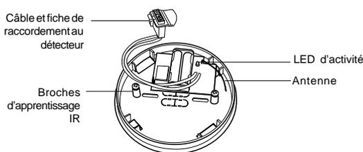
Lorsque de la fumée active le détecteur, celui-ci déclenche à son tour l'émetteur via le câble et la fiche illustrés dans la figure ci-dessus. L'émetteur adresse alors un signal au récepteur.
