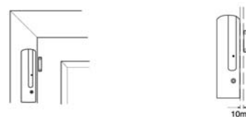
Figure 3. Installation du contact de porte
