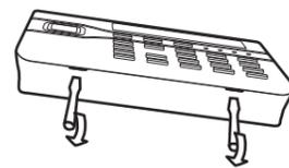
Utiliser délicatement les encoches sous le clavier pour l'ouvrir.
