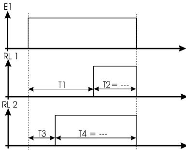
Ce mode n'est opérationnel que si la durée de l'ouverture de boucle de l'entrée **E1** est supérieure au temps réglé pour les temporisation **T1** et **T3**.
