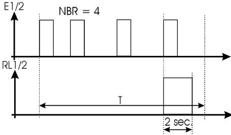
Le relais s'active après un nombre de déclenchement **nbr** de l'entrée dans un temps **T** donné.
