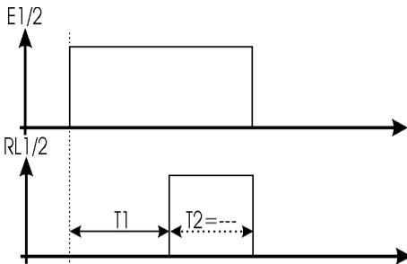
Cette fonction permet de retarder un « défaut permanent » ou de longue durée avec la possibilité de régler le temps avant le déclenchement du relais, mais pas le temps de maintien de celui-ci (défaut technique, coupure de courant, ...).
