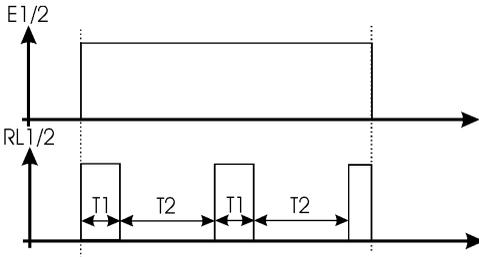
Le relais s'active pendant T1 secondes puis se désactive pendant T2 secondes tant que l'entrée est en boucle ouverte ou tant que le signal de blocage est absent.
