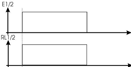
Report de l'état de l'entrée vers le relais de sortie. Ce dernier est activé tant que l'entrée est en boucle ouverte ou tant que le signal de blocage est absent.
