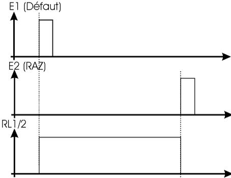
Le relais s'active au déclenchement de E1 (défaut) et reste activé jusqu'au déclenchement de E2 (RAZ ou acquit).
