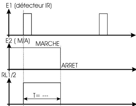
Lors du déclenchement de l'entrée 1 en mode MARCHÉ, le relais s'active jusqu'à ce que le système passe en mode ARRÊT.
