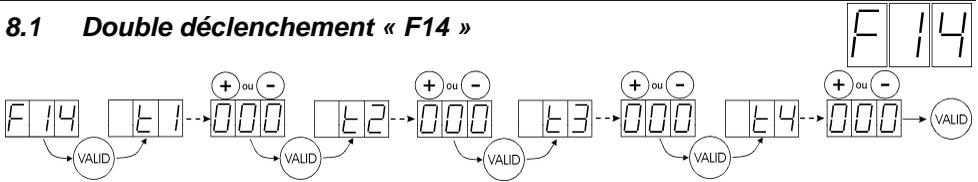
Cette fonction permet le déclenchement décalé de deux sirènes avec un temps différent de retard et de sonnerie pour chacune. Une seule entrée est utilisée pour déclencher les deux sorties.
