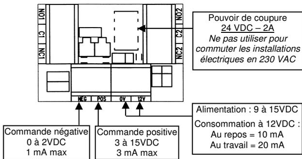
Prévu pour un usage en intérieur sec, le MINI-RT doit être installé à l'intérieur d'un boîtier conformément aux normes de sécurité électrique en vigueur.
