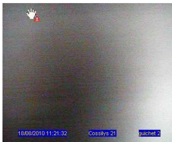
L'icône avec la main indique la détection de masquage
