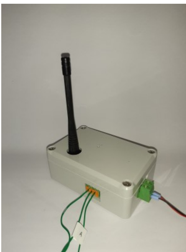
Figure 1. Hub radio Simons Voss avec vue sur la connexion de données (3 fils verts) et la connexion d'alimentation (fils noir et rouge)
